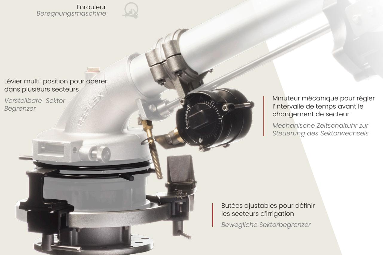
Ces dispositifs brevetés ont été développé par Sime pour aider les agriculteurs ayant des soucis de bordures avec les enrouleurs. Pour les champs à côté de rues, chemins de fer, ou immeubles, les canons Sime équipés de systèmes Rotorkit peuvent être réglés au début de l'opération pour changer automatiquement de secteur d'irrigation au bout d'une certaine durée, afin d'irriguer uniquement la surface désirée.
