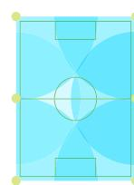
Avec une portée allant jusqu'à 50m, 6 ou 8 arroseurs escamotables suffisent pour couvrir toute la surface d'un terrain de sport.
