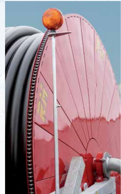
Meldesignal für Ende Schlauchaufwicklung mit Xenon-Leuchte für Programmiergerät RM.
