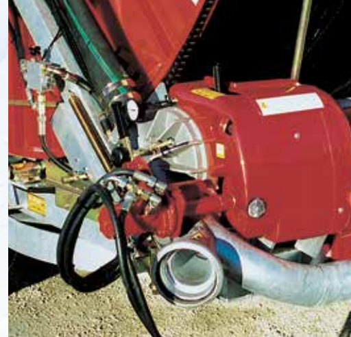
Aufwicklung des PE-Schlauches mittels Hydraulikmotor auf PTO, Geschwindigkeitsregler, Anschlagverteiler und Schnellanschlusspaar an Traktor
