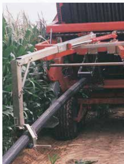
Arm für hintere Schlauchabwicklung (Zubehör für Modelle 790 Gx, 890 Gx, 990 Gx und 1000 Gx), serienmäßig an Magnum Fx.
