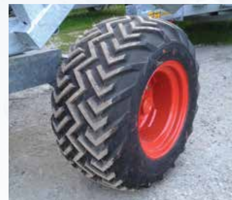
Hochprofilreifen für Mod. 690 Gx Evo und 790 Gx Größe 31x15.50-15
