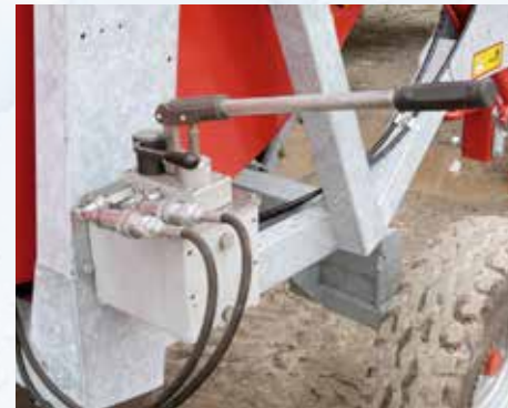
Handpumpe für die Betätigung der hinteren Bügel und Wagenhebung (Zubehör für Modelle 570 Gx Evo, 581 Gx Evo, 690 Gx und 790 Gx).
