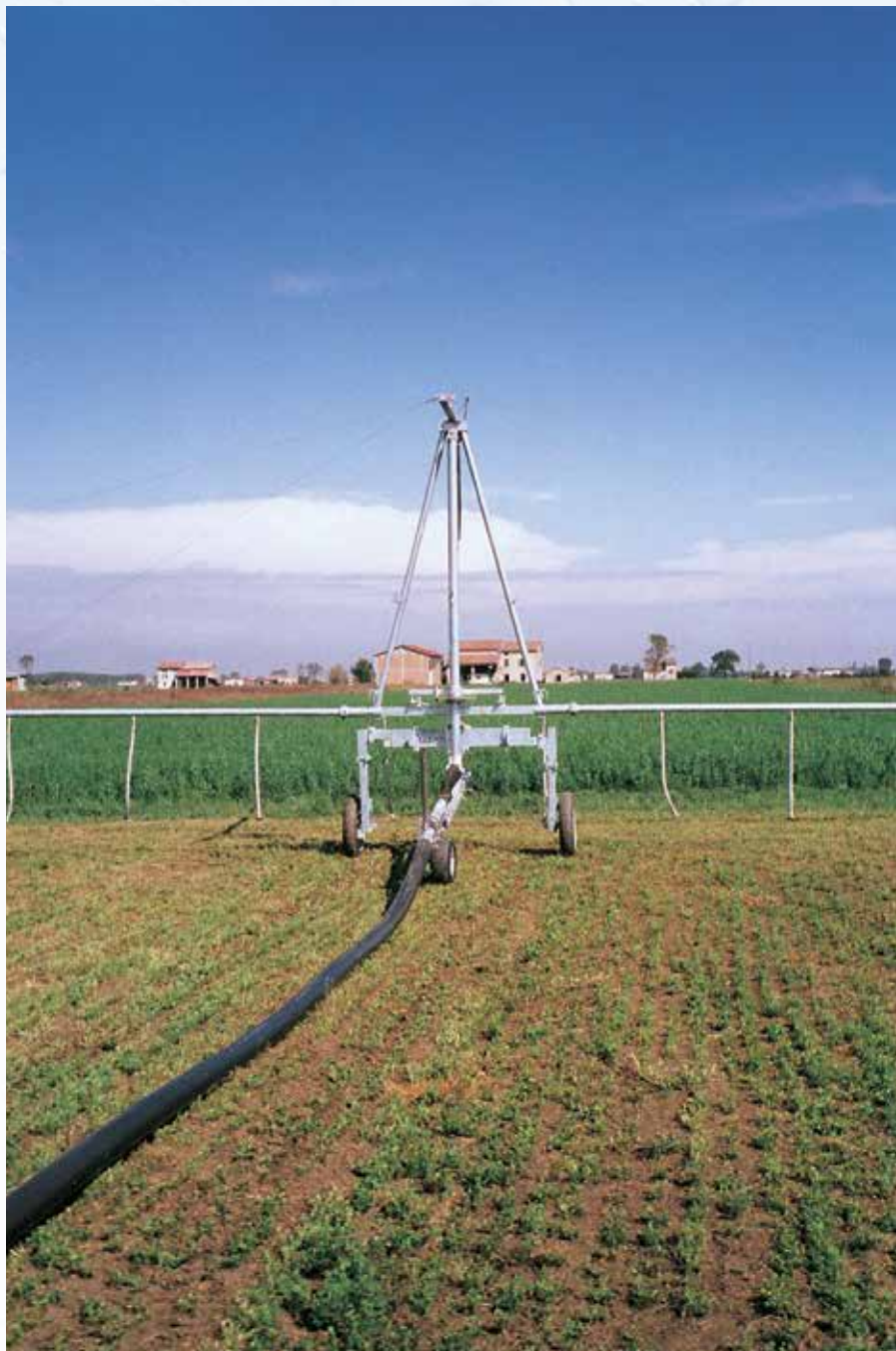
Stahlgestänge für Jaucheverteilung zu 28 Metern mit Senkungen
