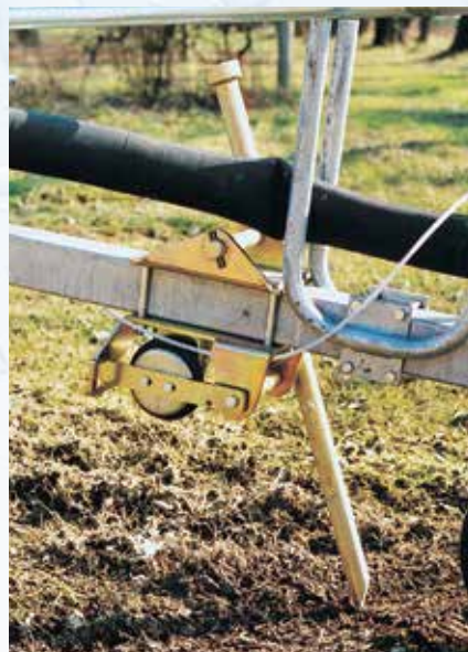
Vorrichtung für Verankerung des Wagens im Boden mit Pickel (für Modelle mit hinterer Schlauchabwicklung)
