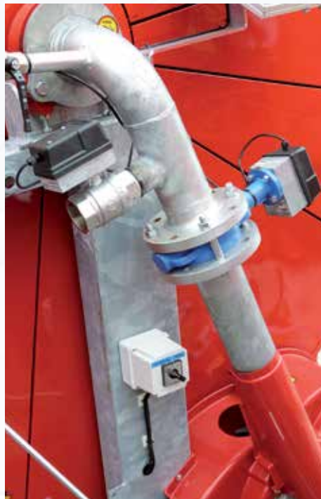
Elektromechanisches Ablaßventil und elektromechanisches Schließventil, die vom Programmiergerät gesteuert werden (getrennt oder zusammen geliefert und von elektrischem Umwandler gesteuert).
