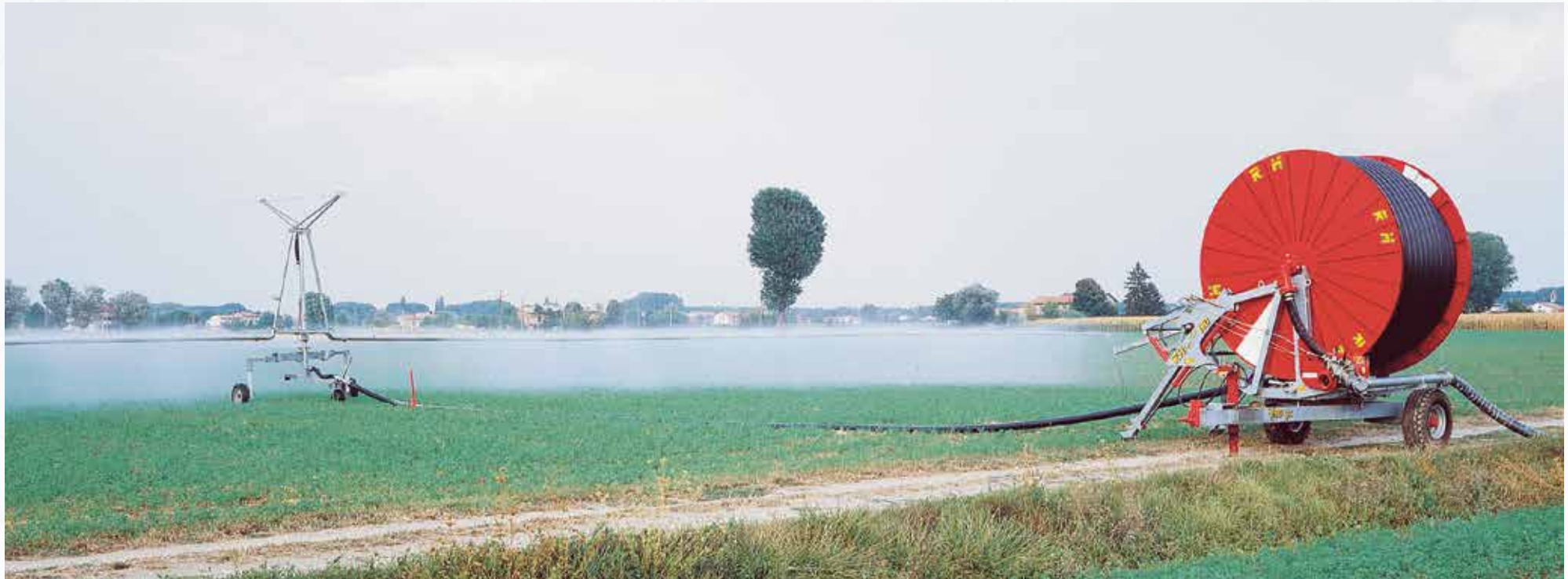
An 890 Gx montiertes Stahlgestänge mit Gestell zu 50 Metern
