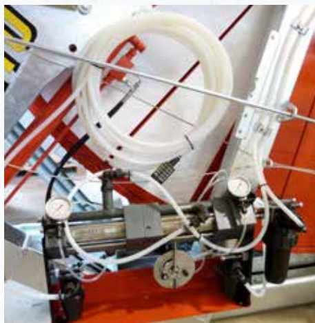
Dosierpumpe für düngende Bewässerung mit Jauche.
