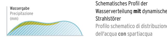
Schematisches Profil der Wasserverteilung **mit** dynamischen Strahlstörer
