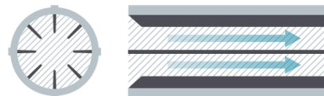
Das Strahlrohr wurde optimiert, damit das Wasser die Düse mit den geringstmöglichen Turbulenzen und Druckverlusten erreicht
