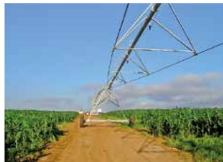
Schnell überziehbar durch einfaches Schwenken der Fahrturmräder
