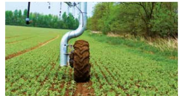
Exakte Steuerung des Cornerspan über GPS oder Untergrundsteuerung.
