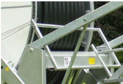
Damit der Beregnungsablauf keine Aufsicht erfordert, ist das Gerät mit einer End- und Sicherheitsabschaltung ausgestattet. Die Endabschaltung wird aktiviert, wenn das Stativ gegen den Schaltbügel drückt und dieser über ein Gestänge den Abschalthebel betätigt. Dadurch wird der Antrieb gestoppt. Um unangenehme Folgen eines fehlerhaft aufgewickelten PE - Rohres zu vermeiden.
