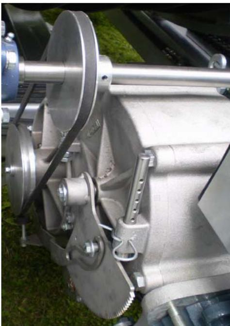
Die Vollstromturbine TVR 60 ist eine speziell entwickelte Antriebsturbine mit großen Durchflussquerschnitten und geringen Druckverlusten. Es sind daher auch hohe Einzugsgeschwindigkeiten bei kleinen Wassermengen erreichbar. Sie hat einen strömungsgünstigen Aufbau und ist direkt auf der Haspelwelle montiert. Sie liefert die für den PE-Rohreinzug notwendige Energie. Die Drehzahl wird direkt von der Laufradwelle abgenommen und über einen Keilriementrieb auf das BAUER - Schaltgetriebe übertragen.
