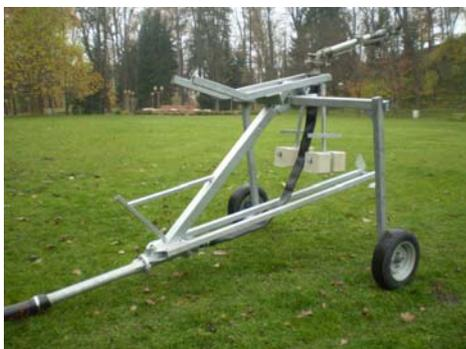
Durch die hohe Bauweise der Radstative symmetrisch sowie asymmetrisch sind diese besonders kulturschonend (Radstativ asymmetrisch ist Option). Die Spurweite ist stufenlos verstellbar und ermöglicht die Anpassung an jeden Reihenabstand. Die Verstellung erfolgt über den Rahmenträger symmetrisch.
