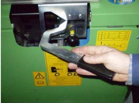
2. Abschalthebel in die Abschaltstellung ziehen und durch langsames, vorsichtiges nach unten ...
