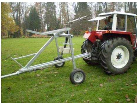
Zum leichteren Ausziehen des PE - Rohres sind die Stative mit einem Ausziehhaken ausgestattet. Die Ackerschiene des Traktors wird in diesen Haken eingehängt und das PE-Rohr ausgezogen.
