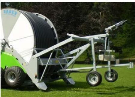
Durch das Ausfahren der Stützen senkt sich das Stativ automatisch in die Position „PE-Rohrauszug“ ab.
