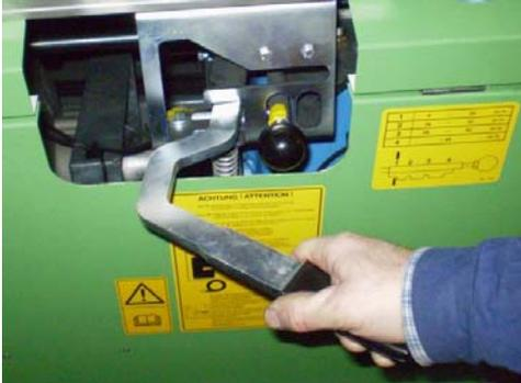
Getriebeschalthebel in Stellung „PE-Rohrauszug“ bringen. Der Schalthebel wird durch eine Feder nach oben gedrückt und verrastet.
