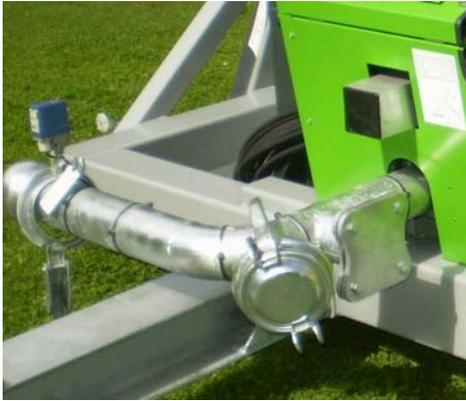
Mit der Abschaltklappe-Überdruck wird am Ende des Beregnungsvorganges die gesamte Wasserzufuhr unterbunden. Schließt das Ventil, steigt der Druck in der Zuleitung an.
