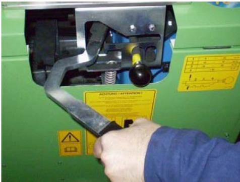
Das Entspannen erfolgt durch vorsichtig dosiertes nach unten drücken des Schalthebels.
