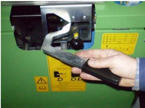
Abschalthebel in die Abschaltstellung ziehen ...
