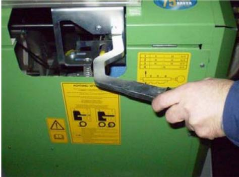
Wenn der Betriebsdruck erreicht ist und beim Weitstrahlregner nur mehr Wasser ohne Luftpneinschlüsse im geschlossenen Strahl austritt, Getriebeschalthebel in Stellung „PE-Rohreinzug“ bringen.
