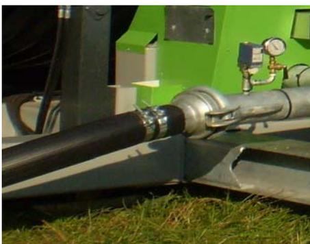
Den Druckschlauch ankuppeln. Die Wasserzufuhr öffnen.
