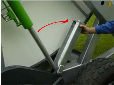
Zylindersicherung bis zum Anschlag ausklappen
