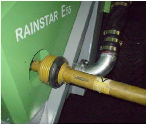
Das PE-Rohr kann bei Bedarf auch mit dem Traktor über eine Gelenkwelle aufgehaspelt werden.
