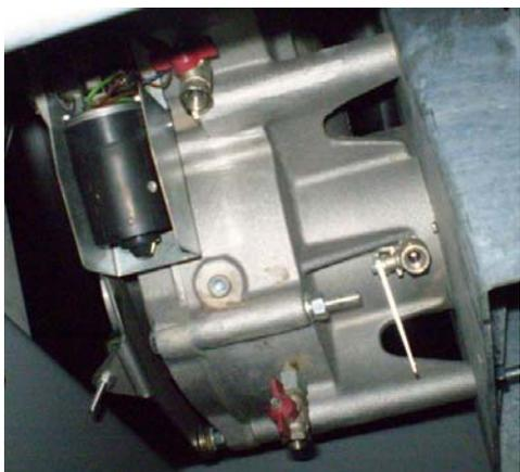
Turbine – beide Kugelhähne öffnen
