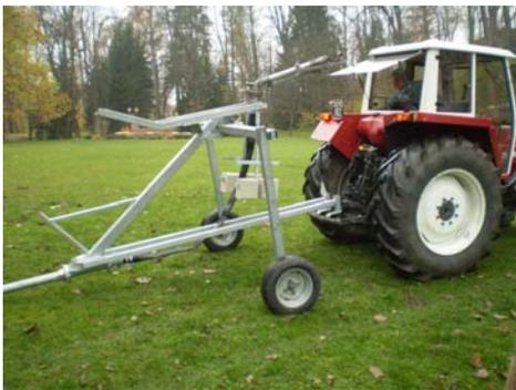
Ackerschleife in Ausziehhaken einhängen und Stativ ausziehen.
