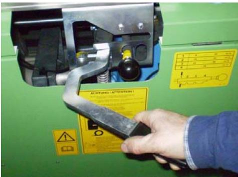
Der Abschalthebel muss in Stellung „PE - Rohrauszug“ gebracht werden.
