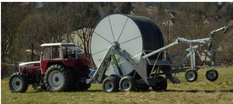
Während des Transportes befindet sich das Stativ am Liftrahmen aufgesattelt in hochgehobener Position. Die Gerätestützen sind nach oben geklappt und der Deichselstützfuß ist ganz eingefahren. Mit dem RAINSTAR zum Aufstellplatz fahren. Beim Abstellen des RAINSTARs darauf achten, dass die senkrechte Drehachse des Gerätes in der Mitte der Beregnungsgasse oder zweier Zeilen der Kultur zum Stehen kommt.
