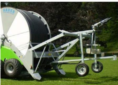
Nach erfolgtem Rohreinzug können die Stützen mit der Traktorhydraulik vorsichtig eingezogen werden, dabei wird das Stativ automatisch hochgehoben und in die Transportstellung gebracht.
