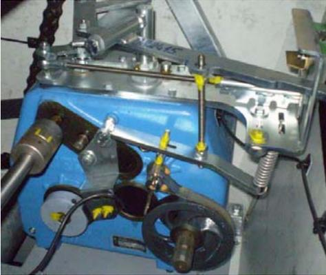
Das BAUER - Schaltgetriebe untersetzt die Turbinendrehzahl entsprechend der eingestellten Turbinendrehzahl. Das Getriebe ist mit 4 Schaltstufen ausgestattet. Der Stop für den Haspelantrieb am Ende eines Beregnungsstreifens wird durch Auskuppeln der Zahnkupplung sichergestellt.
