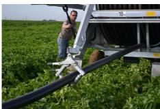
Über den Hydraulischem Schwenkarm das PE-Rohr in die gewünschte Ablageposition bringen.
