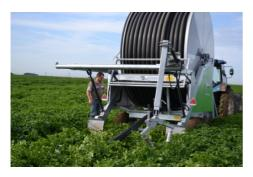
Über die Hydraulik den Schwenkarm mit dem geöffnetem Rollenfenster über das PE-Rohr schwenken und danach auf das PE-Rohr absenken.
