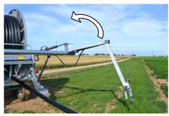
Nach dem ablegen des PE-Rohres das Rollenfenster öffnen und den Schwenkarm hochklappen um den Bereich für den Stativeinlauf freizugeben.
