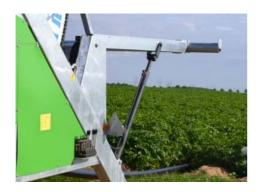
Die Hydraulikzylinder vom Stativlift müssen komplette eingefahren werden um die richtige Position für den Stativeinlauf zu gewährleisten.
