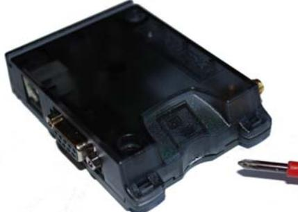
Datenübertragungs- , Strom- und Antennenkabel anschließen.
