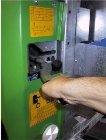
Getriebeschalthebel in Stellung „PE-Rohrauszug“ bringen. Der Schalthebel wird durch eine Feder nach oben gedrückt und verrastet.
