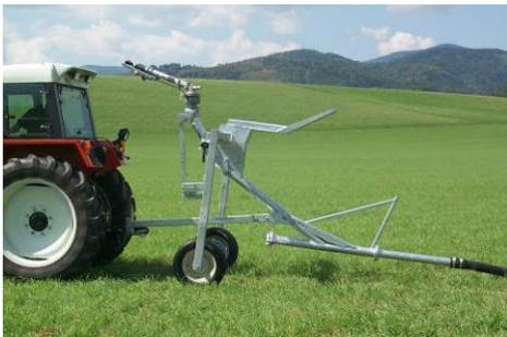
Ackerschiene in Ausziehhaken einhängen und Stativ ausziehen.
