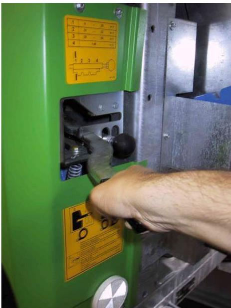
Der Abschalthebel muss in Stellung „PE - Rohrauszug“ gebracht werden.
