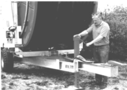
Mit dem Deichselstützfuß das Fahrgestell etwa waagrecht einrichten.
