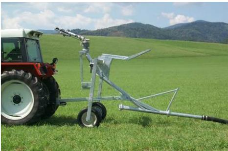
Zum leichteren Ausziehen des PE - Rohres sind die Stative mit einem Ausziehhaken ausgestattet. Die Ackerschiene des Traktors wird in diesen Haken eingehängt und das PE-Rohr ausgezogen.
