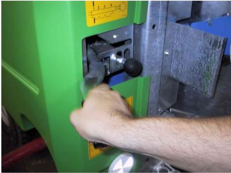
... und durch vorsichtiges dosiertes nach unten drücken des Abschalthebels, das PE - Rohr entspannen.
