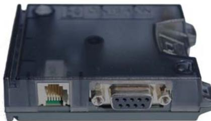
Das **BGS2T GSM Modem von Cinterion** verfügt über ein LED, das den Status anzeigt.
