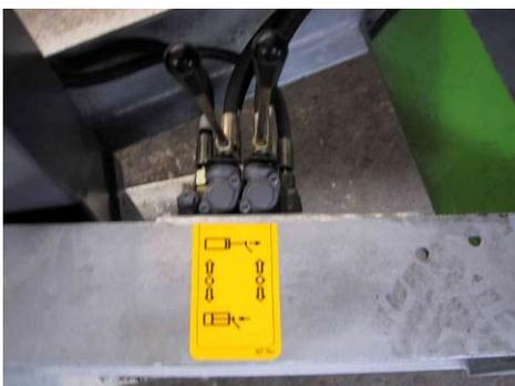
Das Ein- u. Ausfahren der Geräteabstützung wird mit der OPTION „Steuerventilblock - Abstützung“ wesentlich erleichtert.
