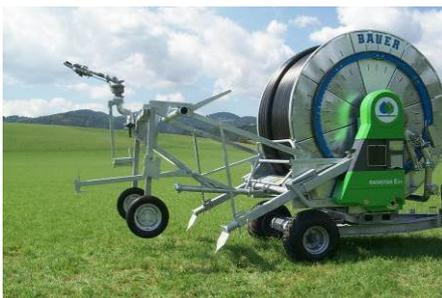
Nach erfolgtem Rohreinzug können die Stützen mit der Traktorhydraulik vorsichtig eingezogen werden, dabei wird das Stativ automatisch hochgehoben und in die Transportstellung gebracht.
