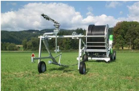
Nun mit dem Gerät 2 - 3m weiterfahren, die Geräteabstützung einziehen und weiter durch das Feld fahren.
