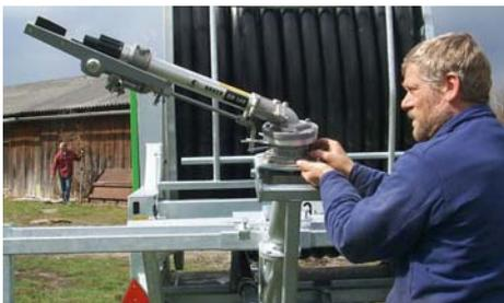
Beim Weitstrahlregner den Sektor einstellen (ca. 220° für volle Streifenbreite). Weitere Hinweise siehe eigene Betriebsanleitung für den Regner. Der VARI-ANGLE kann durch Verstellen des Strahlerhebungswinkels auf die vorherrschenden Windverhältnisse abgestimmt werden.
