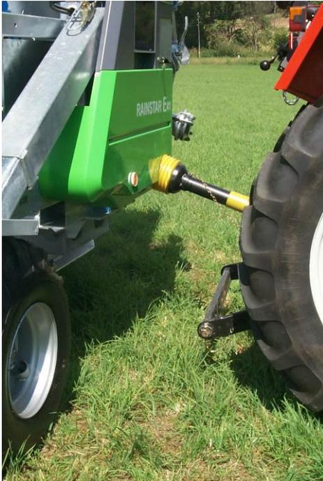
Das PE-Rohr kann bei Bedarf auch mit dem Traktor über eine Gelenkwelle aufgehaspelt werden.
