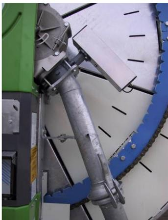
Mit der Abschaltklappe-Überdruck wird am Ende des Beregnungsvorganges die gesamte Wasserzufuhr unterbunden. Schließt das Ventil, steigt der Druck in der Zuleitung an.
