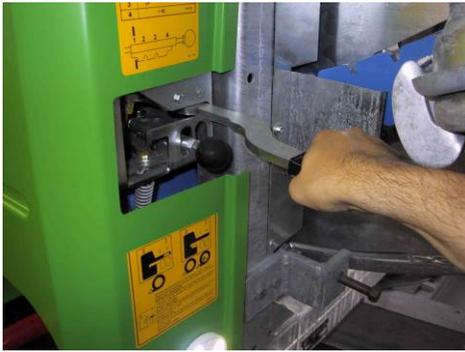
Wenn der Betriebsdruck erreicht ist und beim Weitstrahlregner nur mehr Wasser ohne Lufteinschlüsse im geschlossenen Strahl austritt, Getriebeschalthebel in Stellung „PE-Rohreinzug“ bringen.
