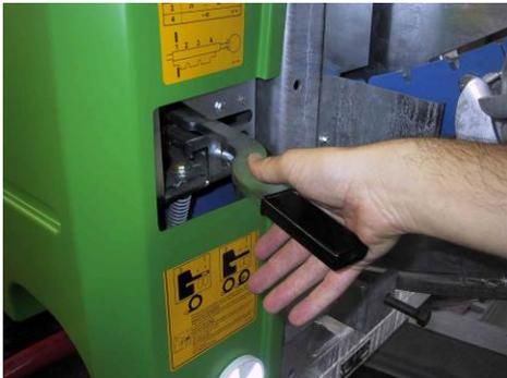
Abschalthebel in die Abschaltstellung ziehen ...
