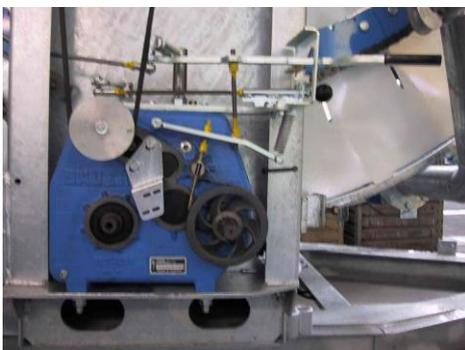
Das BAUER - Schaltgetriebe untersetzt die Turbinendrehzahl entsprechend der eingestellten Turbinendrehzahl. Das Getriebe ist mit 4 Schaltstufen ausgestattet. Der Stopp für den Haspelantrieb am Ende eines Beregnungsstreifens wird durch Auskuppeln der Zahnkupplung sichergestellt.
