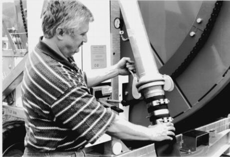
Den Druckschlauch ankuppeln. Die Wasserzufuhr öffnen.
