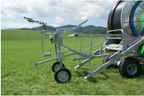
Durch das Ausfahren der Stützen senkt sich das Stativ automatisch in die Position „PE-Rohrauszug“ ab.
