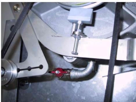
Turbine – Kugelhahn öffnen
