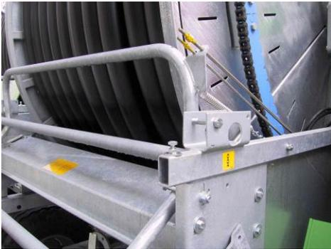
Damit der Beregnungsablauf keine Aufsicht erfordert, ist das Gerät mit einer End- und Sicherheitsabschaltung ausgestattet. Die Endabschaltung wird aktiviert, wenn das Stativ gegen den Schaltbügel drückt und dieser über ein Gestänge den Abschalthebel betätigt. Dadurch wird der Antrieb gestoppt. Um unangenehme Folgen eines fehlerhaft aufgewickelten PE - Rohres zu vermeiden.
