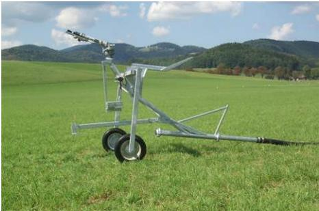
Durch die hohe Bauweise der Radstative symmetrisch sowie asymmetrisch sind diese besonders kulturschonend (Radstativ asymmetrisch ist Option). Die Spurweite ist stufenlos verstellbar und ermöglicht die Anpassung an jeden Reihenabstand. Die Verstellung erfolgt über den Rahmenträger symmetrisch.
