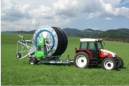
Beim Transport soll die Haspel in Fahrtrichtung gedreht und mit dem Vorstecker gesichert sein. Das Stativ, der Deichselstützfuß sowie die beiden hinteren Gerätestützen müssen hochgehoben bzw. eingefahren sein. Den RAINSTAR bei seitlichem PE-Rohrabzug am Feldrand rechtwinklig zum vorgesehenen Beregnungsstreifen abstellen und vom Traktor abhängen.
