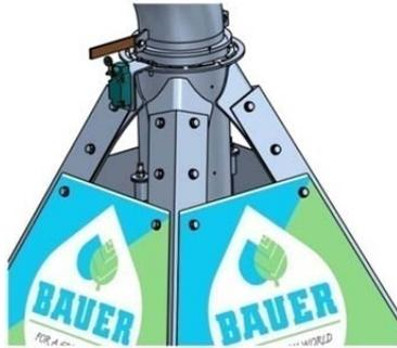
Durch einen am *Zentralturm* montierten Schaltarm wird ein Grenztaster betätigt, der die Maschine in einer bestimmten, gewünschten Stellung (*Parkstellung*) automatisch zum Stillstand bringt.
