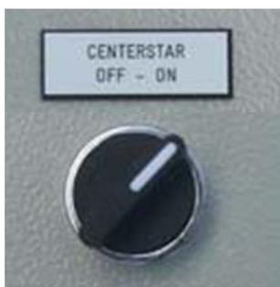
4. Schalter "CENTERSTAR ON - OFF" in Stellung "ON" schwenken.
