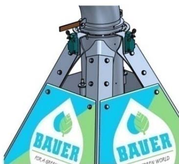
Auf dem *Zentralturm* sind 2 Grenztaster montiert, die in beliebiger Position, für die Einstellung des Sektors, fixiert werden können. Durch einen am Zentralturmbogen montierten Schaltarm werden die Grenztaster betätigt.
