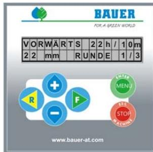
2. Taste "FORWARD" oder "REVERSE" drücken und gedrückt halten, um die richtige Fahrtrichtung einzustellen. Jene Fahrtrichtung wählen, die das äußerste Maschinenende in die radiale Flucht bringt.
